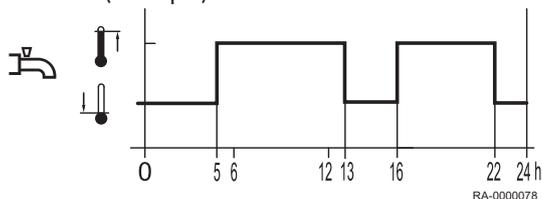
Programme horaire 4/ECS: La température ECS est changée entre la consigne de température ECS et la consigne de température ECS réduite indépendamment des programmes de commutation horaire du circuit de chauffage. On utilise pour cela le programme de commutation de l'heure 4.
