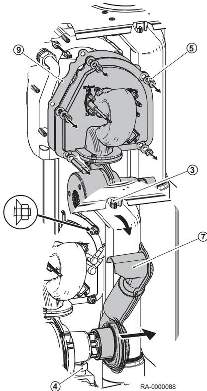
1. Débrancher les câbles de connexion électrique avec le ventilateur sur le coupleur.
