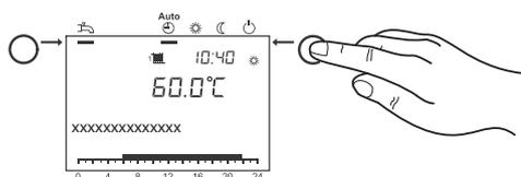
La **touche du mode de fonctionnement pour le mode de chauffage** active un passage entre les différents modes de chauffage. Le réglage sélectionné est marqué avec une barre sous le symbole du mode de fonctionnement.
