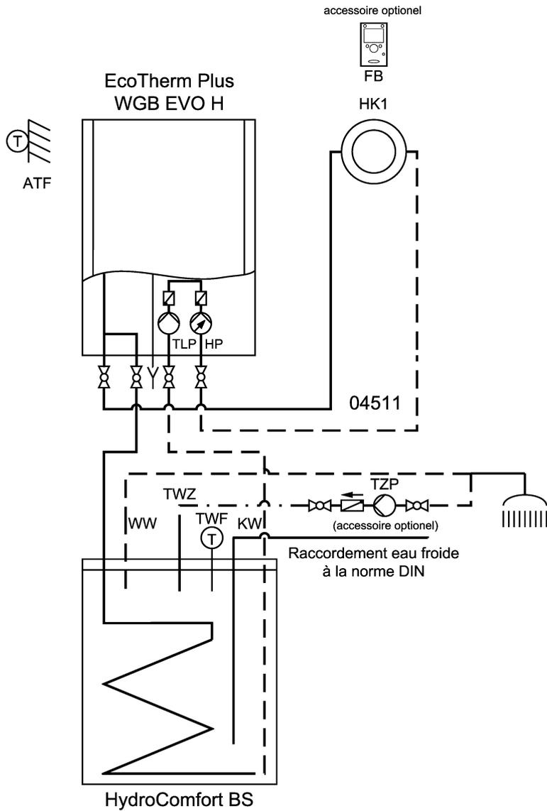
Fig.11 Schéma de raccordement
