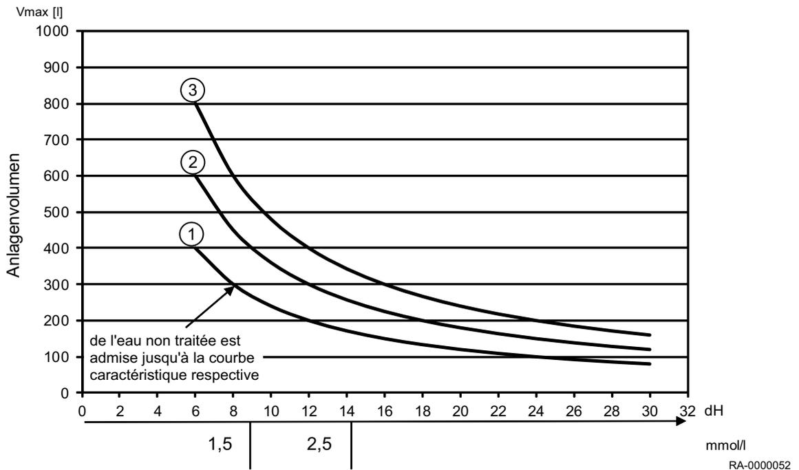
Tab.7 Clé du diagramme de dureté de l'eau
